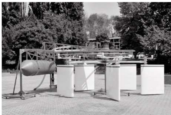
Fig. 3. Prototipul industrial al microhidrocentralei de conversie a energiei cinetice a apei (a) instalat pe r. Prut, c. Stoieniști, Cantemir (b).
