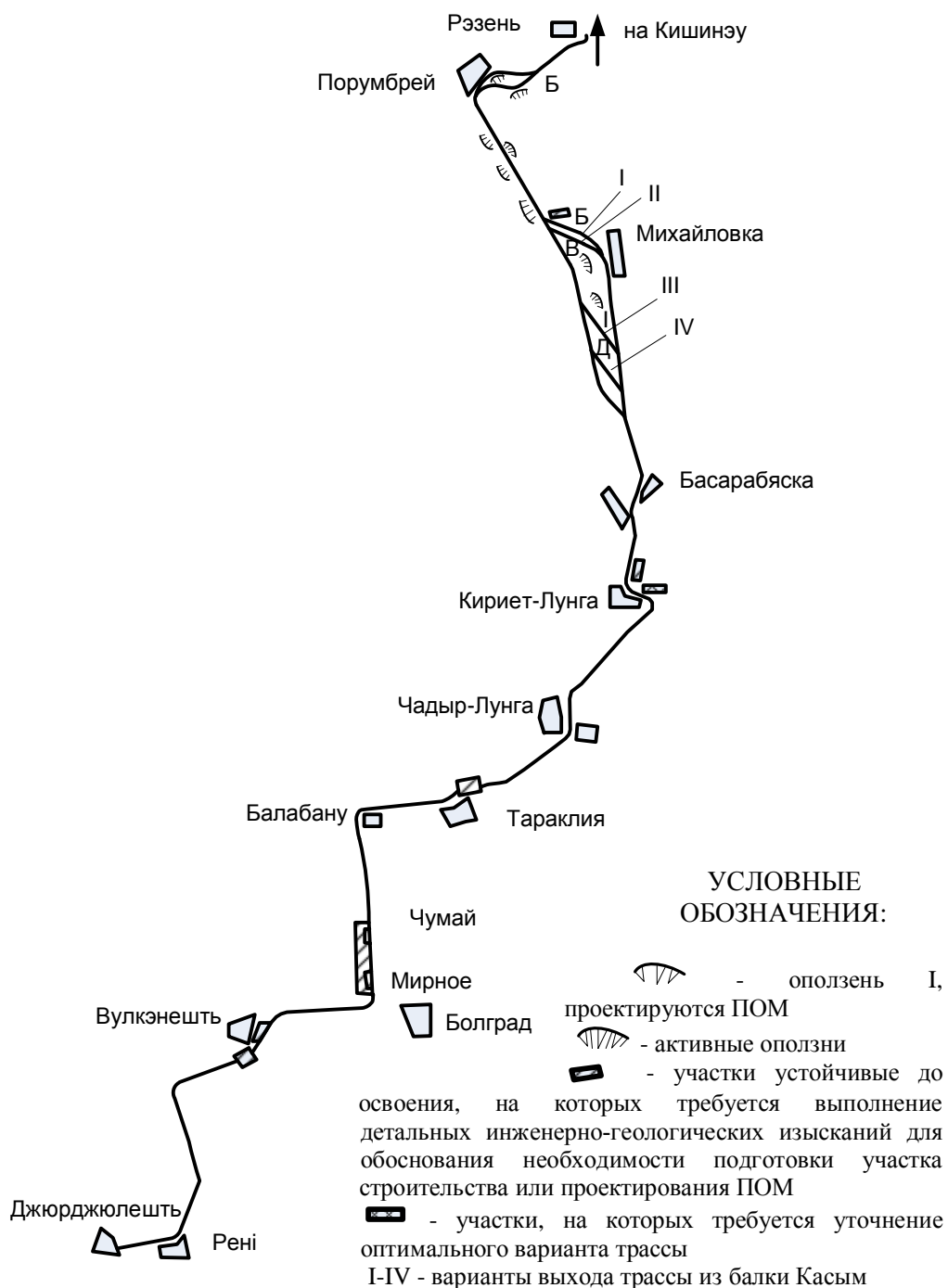
Рис. 1. Схема оползневой опасности трассы Кишинэу-Джурджюлешть.
