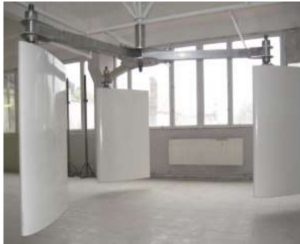
Fig. 9. Rotor cu 3 pale hidrodinamice fabricat în Laboratorul Centrului de Elaborare a Sistemelor de Conversie a Energiilor Regenerabile, UTM.
