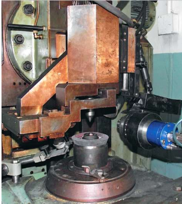
Figura 8.39. Mașină-unealtă cu dispozitivul de generare G_{r,s}^{disc} prin frezare a danturilor cu profil convex/concav al dinților
