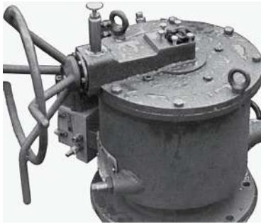
Figura 9.43. Turbomotor precesional cu ejecție reactivă pentru armătura magistralelor de gaz: (a) desen tehnic; (b) prototip industrial fabricat la uzina Kompressormas (Ucraina); (c) turbomotor agregatizat cu conducta de gaz
