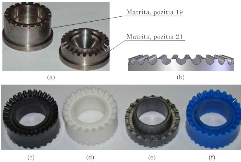
Figura 8.63. Modelul 3D ale danturilor matritelor cu profil oglindă (a), mostre ale matritelor fabricate (b) și mostre de roți-satelit (fabricată la Uzina “Sigma”, Chișinău) (c), Hostaform C 9021 (d), poliamid 6 (e), Hostaform M 9021 (f)
