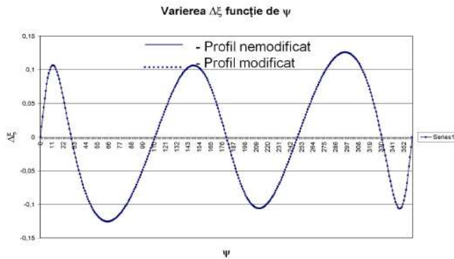
Figura 8.26. Abaterea \Delta pe axa \xi ( \Delta\xi = f(\psi) ) a profilului modificat în raport cu cel nemodificat
