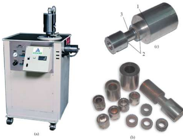
Figura 8.68. Utilajul tehnologic de presare individuală: a roților centrale cu profil convex/concav al dinților (a); a roților-satelit cu două coroane cu dinți în arc de cerc (b); matrițe și mostre de roți dințate cu diametrul de 24, 38, 46, 62 mm (c)
