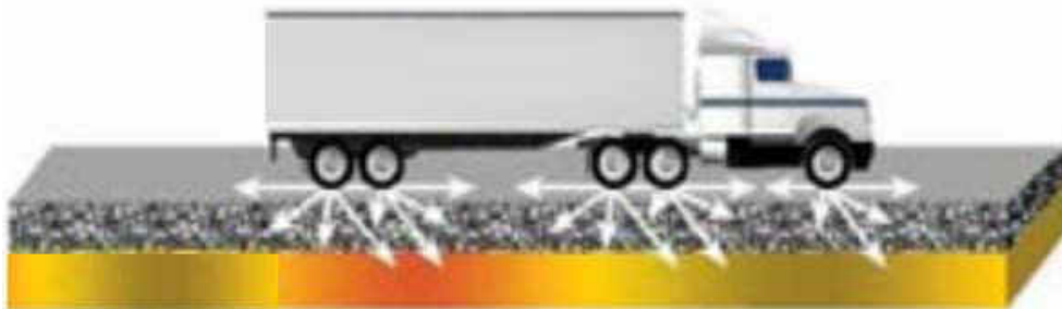
Figura 1. Model de distribuirea greutății uniform pe întregul strat, reducând uzura pavajului rutier armat cu fibra de bazalt
