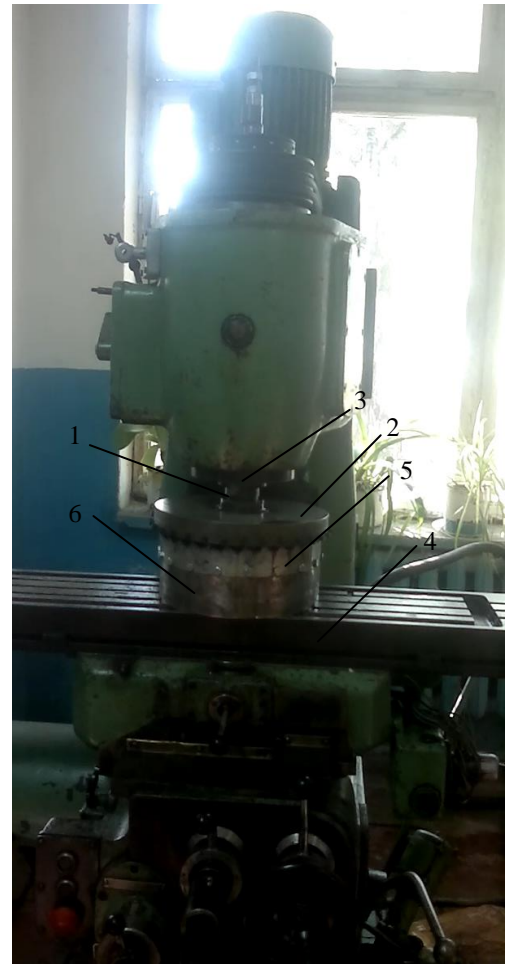
Fig. 1. Dispozitivul de deformare plastică în baza mașinii unelte de frezat vertical tip 6H11.
