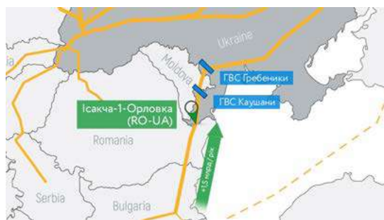
Figura 3.2.2. Schema de asigurare a fluxului reversibil prin gazoductul transbalcanic 80
