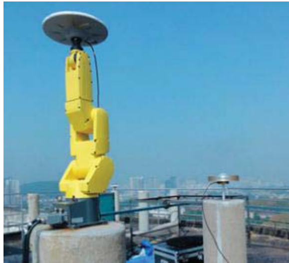
Fig. 2. Determinarea centrului de fază a antenei GNSS
