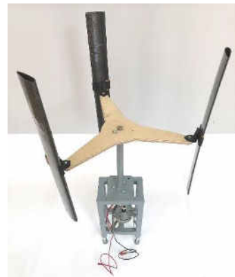
Fig. 4. Modelul experimental al turbinei eoliene cu ax vertical
