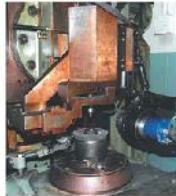
Dispozitivul de generare a danturilor angrenajelor procesate
