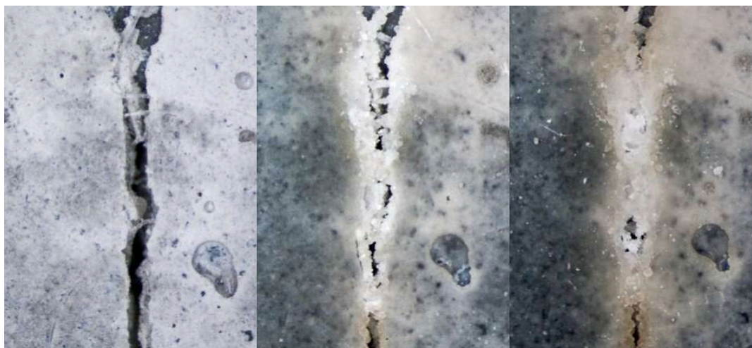
Fig. 3. Procesul de autorefacere a betonului
