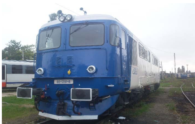
Fig. 1. Locomotiva diesel-electrică de 2100 CP echipata cu motor Sulzer 12 LDA 28.
