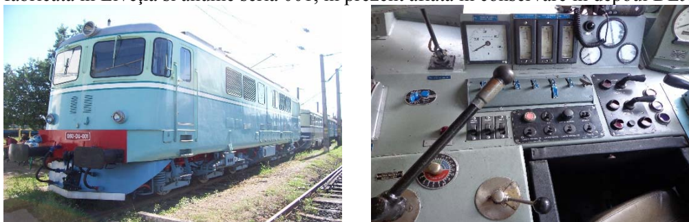
Fig.2. Locomotivă diesel-electrică DA 001 și pupitrul de conducere.
