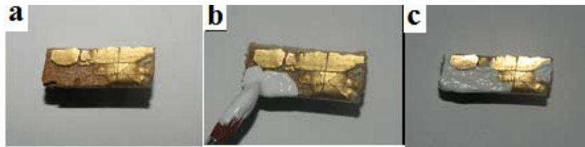
Fig. 9. Proba nr. 1: a – dupa uscarea liantului acrilic; b – in timpul aplicarii Gesso-ului acrilic; c – dupa aplicarea Gesso-ului acrilic.
