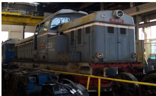
Fig. 4. Locomotiva diesel-electrică de 1250 CP.
