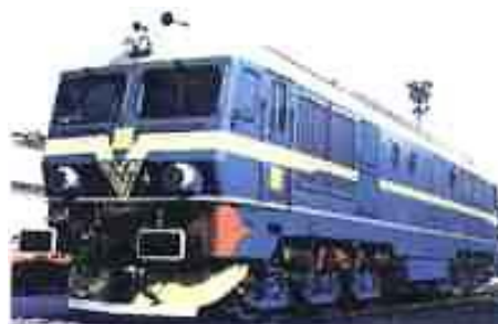
Fig. 2. Locomotiva diesel-electrica de 3000 CP cu motor diesel tip ALCO.
