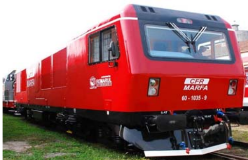
Fig. 6. Locomotiva diesel-electrică Carpathia 2300 DE-M.
