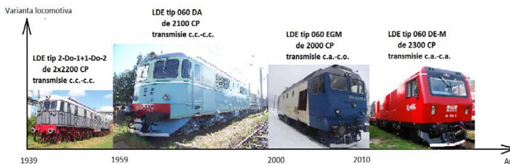
Fig. 7. Evoluția tehnică a locomotivei diesel-electrice 060 DA.
