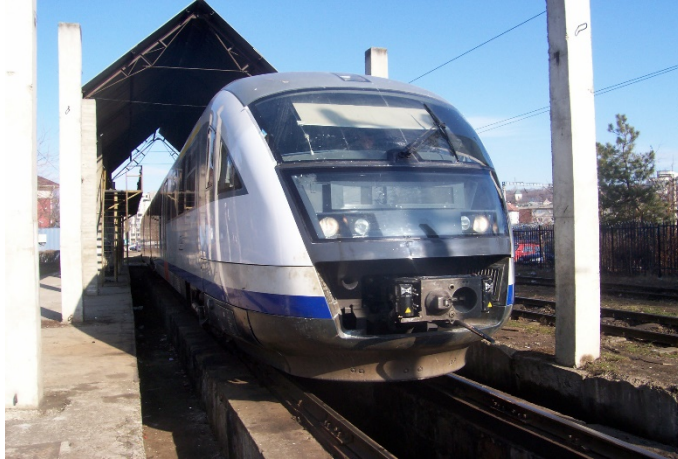
Fig. 3. Automotor Desiro la o revizie între trenuri pe o linie cu canale.
