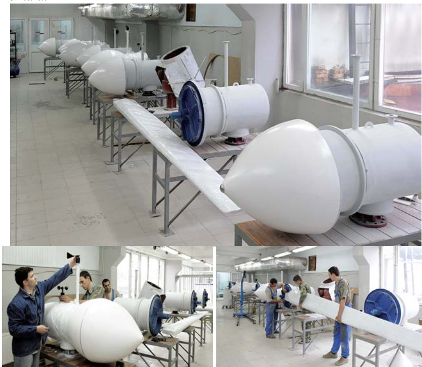
Fig. 26. Asamblarea seriei “0” din 10 turbine eoliene cu puterea de 10 kW, elaborate la UTM.
