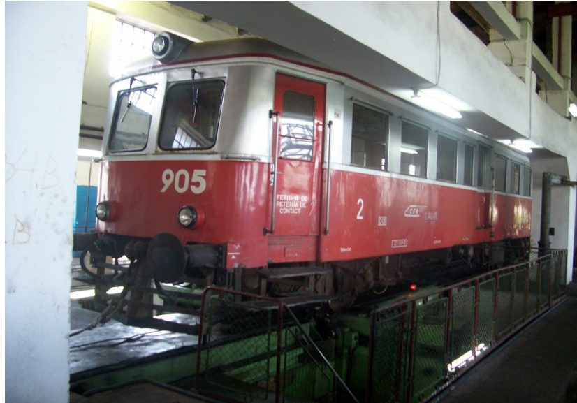
Fig. 5. Automotor seria 900 pe strungul de reprofilare bandaje
