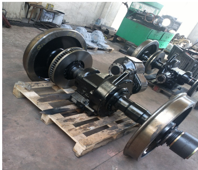
Fig. 4. Osiile motoare ale automotorului Desiro în hala de reparații
