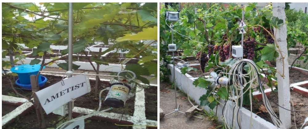
Figura 3.-4. - Măsurări în lizimetre regim automat în faza de maturare a strugurilor
