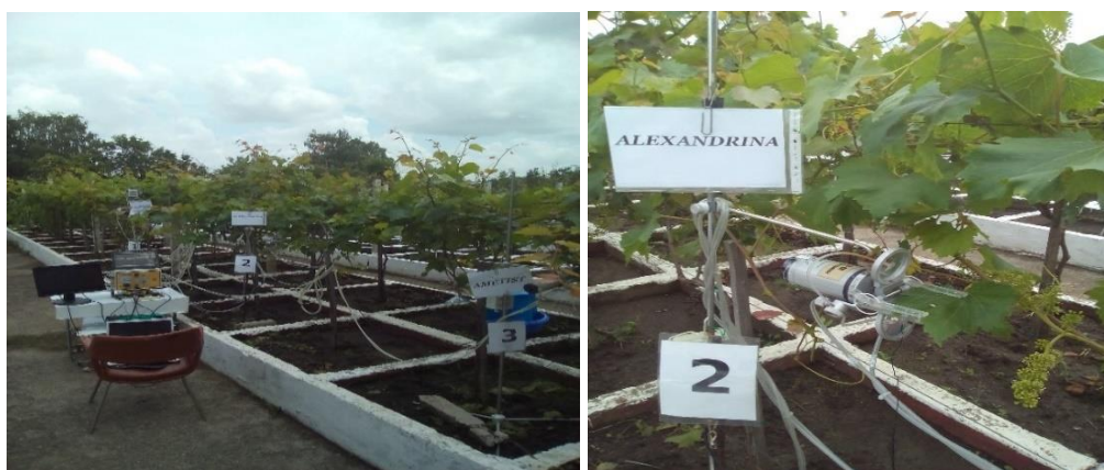
Figura 1.-2. Măsurări în lizimetre regim automat la operația în verde
