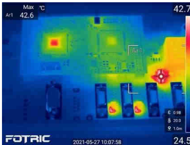
Fig. 6. Defecte de montare
