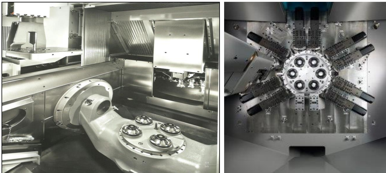
Fig.2. Masă rotativă basculantă ( oscilantă ) cu posibilitatea utilizării de mese paletabile [1-4].
