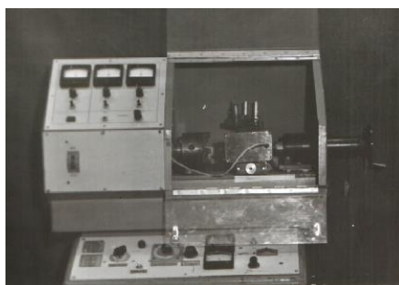
Fig. 1. Instalația pentru cercetarea proceselor de depunere a straturilor din pulberi metalice.
