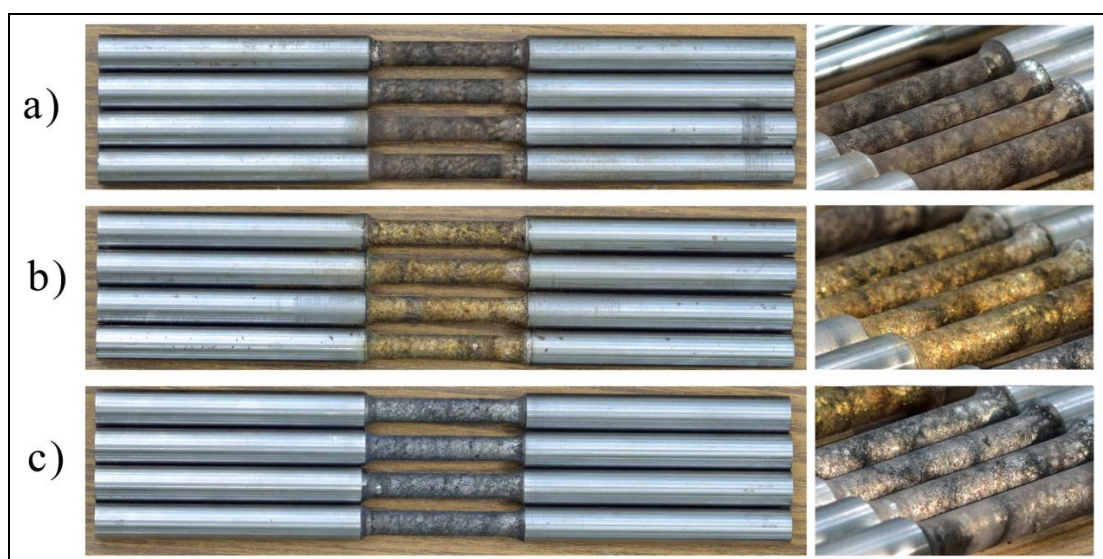
Fig. 4. Vederea generală a probelor din Oțel 35 supuse prelucrării a) TiC ; b) BrA7; c) MoC.
