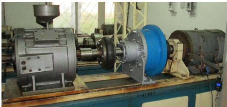
Fig. 2. Standul experimental pentru încercarea transmisiei precesionale în regim de reductor.
