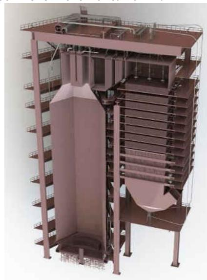
**Рис.12. Продольный разрез прототипа котла на паропроизводительность 500 т/ч спроектированный для сжигания бурых канко-ачинских углей, оснащенного топочным устройством с вертикальным прецессионным вихрем.**<sup>14</sup>
