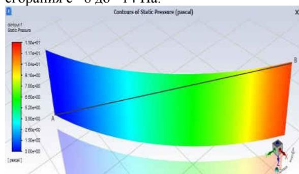
Рис.6. Поле статического давления в воздушном сопле.<sup>6</sup>
