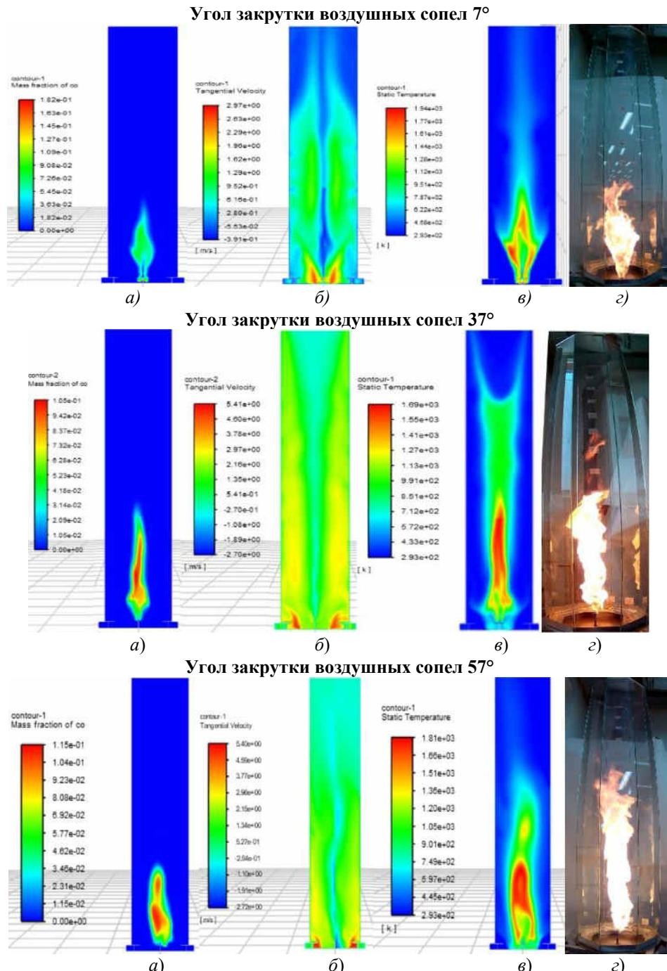
**Рис.3. Сопоставление результатов расчетных характеристик вертикального прецессирующего вихря, выполненных в ПО ANSYS Fluent с данными натурных испытаний.<sup>3</sup>**
