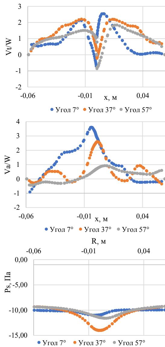
**Рис.5. Зависимости изменения тангенциальной и аксиальной скоростей, статического давления от угла закрутки воздушных сопел: расход газообразного топлива составлял 5 мг/с; высота расположения расчетного сечения составляла 100 мм.**<sup>5</sup>
