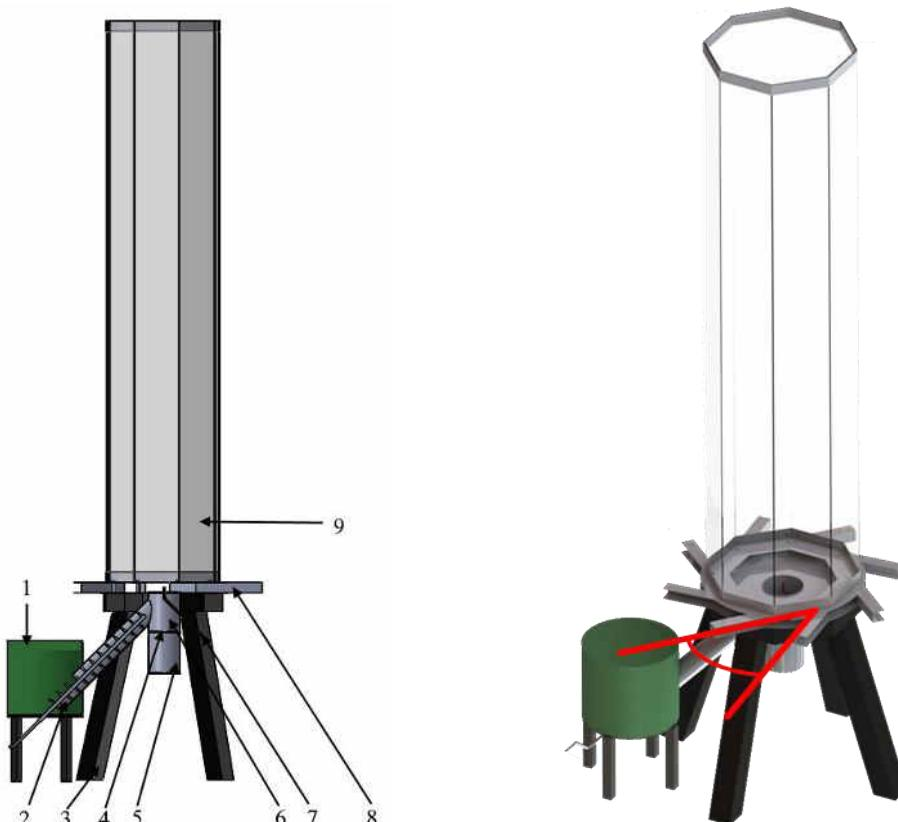
1 – бункер угольной пыли; 2 – питатель пыли (шинек); 3 – опора; 4 – ВРП; 5 – короб для подачи воздуха; 6 – камера псевдосжиженного кипящего слоя; 7 – патрубок подачи газообразного топлива; 8 – направляющие воздушные сопла; 9 – стеклянные экраны камеры догорания
