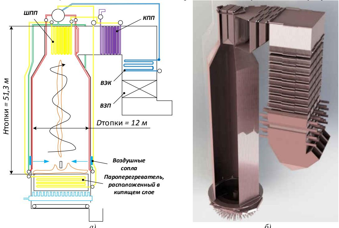
ШПП – ширмовый паропререгреватель; КПП – конвективный паропререгреватель; ВЭК – водяной экономайзер; ВЗП – воздухоподогреватель
