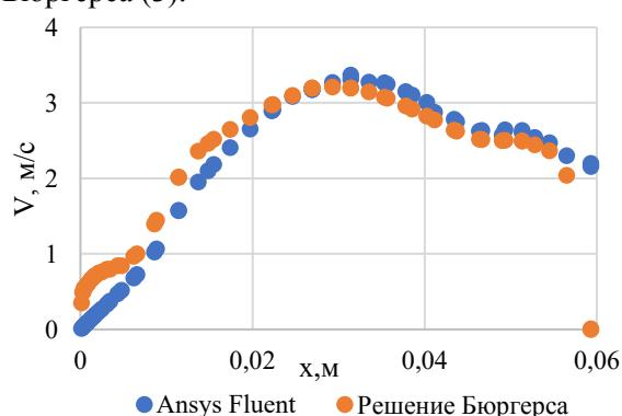
**Рис.4. Сравнительная оценка распределения тангенциальной скорости вертикального прецессирующего вихря, полученная с помощью ANSYS Fluent и модели Бюргерса.**<sup>4</sup>
