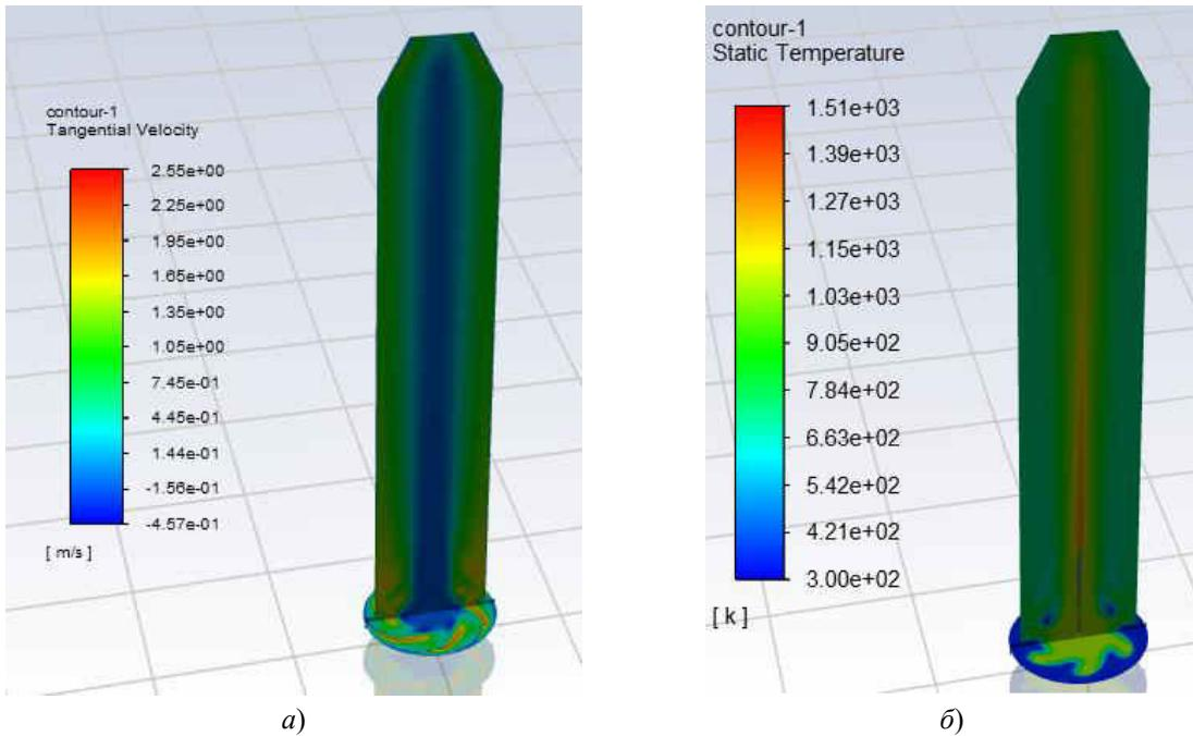
*a – поле тангенциальной скорости газового вихря; б – поле температур в плоскости продольного и поперечного сечения топки на высоте размещения воздушных сопел*
