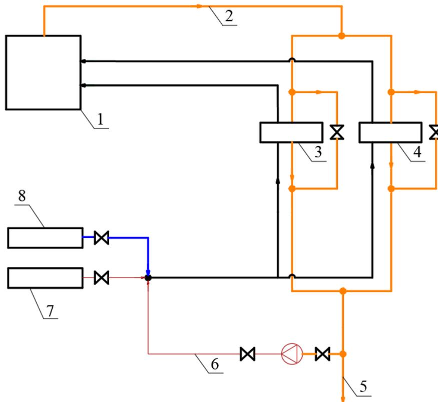
1 – паровой котел, 2 – дымовые газы, 3 – трубчатый воздухоподогреватель №1 (ТВП-1), 4 – трубчатый воздухоподогреватель №2 (ТВП-2), 5 – уходящие газы, 6 – газы рециркуляции, 7 – вход кислорода, 8 – вход воздуха
