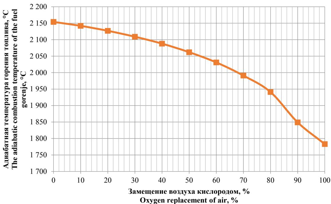
Рис. 10. Зависимость адиабатной температуры горения от доли замещения воздуха кислородом.
