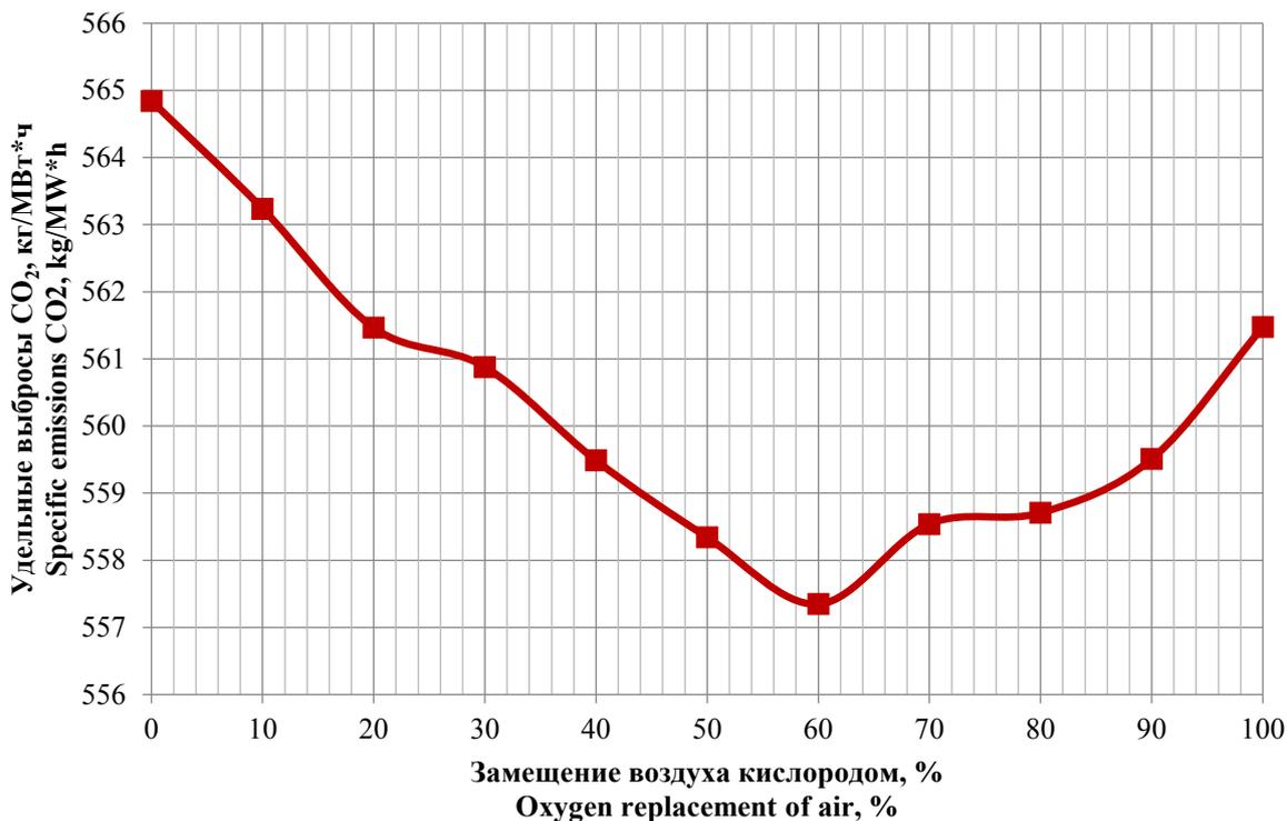
Рис. 7. Зависимость удельных выбросов CO<sub>2</sub> от доли замещения воздуха кислородом.
