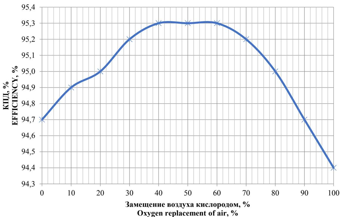
Рис. 8. Зависимость КПД котлоагрегата от доли замещения воздуха кислородом.
