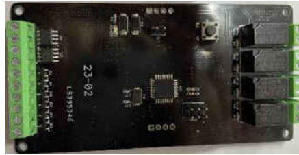
Figura 4.23. Aspectul exterior al modului MEE-32-02
