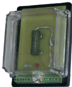
Figura 4.7. Aspectul emulatorului cuptorului ЭП10
