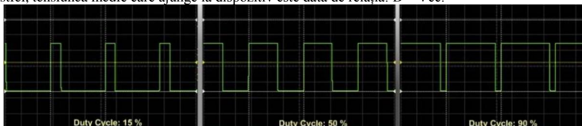
Fig. 1. Semnal PWM cu diferiți factori de umplere.
