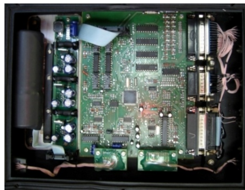
Fig.5. Sistemul de control al echipamentului SDMC-103
