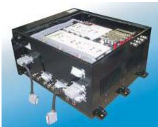
Fig.2. Echipamentul TV Progress de tracțiune al troleibuzelor Solaris Trollino 12DC (Cegelec, Cehia)
