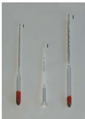
Fig.1 Reprezentarea :1) zaharimetru "Babo" Klosterneuburg, 2) vinometru, 3) alcoolmetru.
