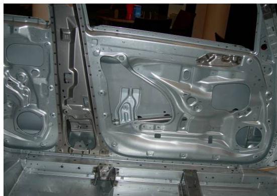
Fig. 2 – Utilizarea oțelului DP 500 la fabricarea porțiunii externe a portierei de automobil "bi modul" cu reducerea grosimii tablei la numai 0,48 mm
