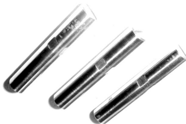
Figura 1. Pivoturi de fuzetă ale autogreiderului DZ-99
