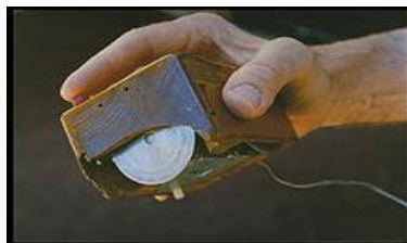
Figura 2 Primul mouse deținut de Douglas Engelbart . Roata din imagine realizează contactul cu suprafața de lucru.
