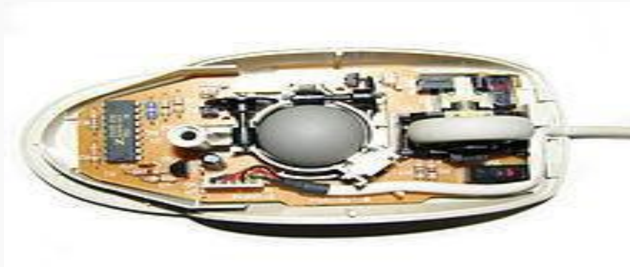
Figura 3 Mouse-ul mecanic, prezentat cu capacul superior eliminat. Rotița de derulare este de culoare gri.
