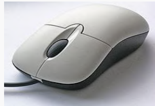
Figura 1 Un mouse modern cu cele mai comune caracteristici: două butoane și o roțiță de derulare.
