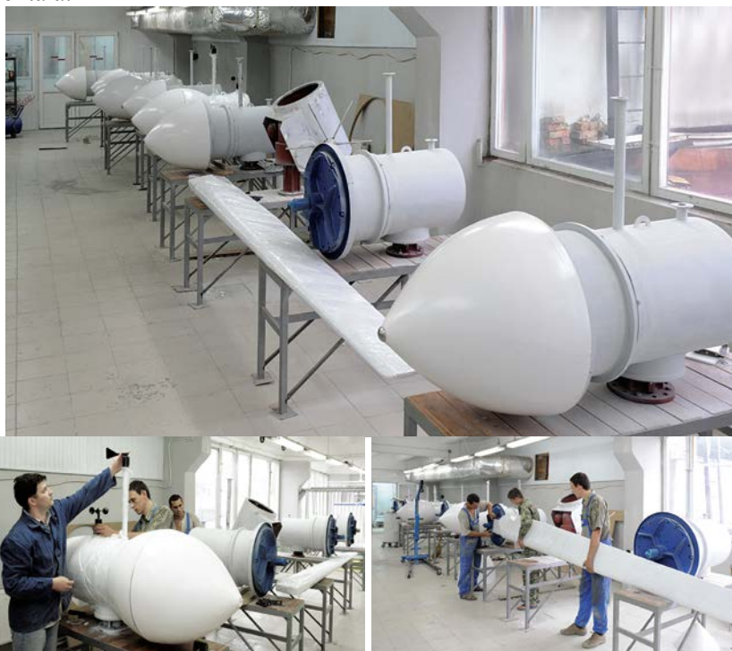
Fig. 26. Asamblarea seriei “0” din 10 turbine eoliene cu puterea de 10 kW, elaborate la UTM.
