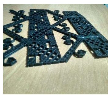
Figura 13. Modulul strugure printat 3D în TPE.
