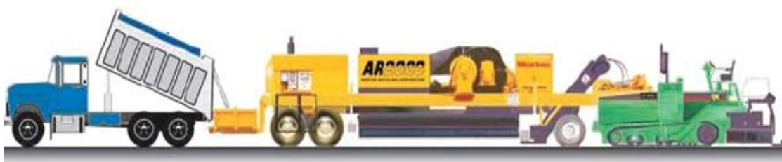
Fig. 6 Echipament ecologic pentru reciclarea la cald a asfaltului [19]
