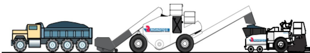
Fig. 5. Tehnologie și echipament ecologic pentru reciclarea la rece a asfaltului [12]
