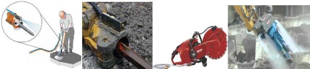
Fig. 3 Echipamente dotate cu sistem de pulverizare a apei [7, 8, 10]
