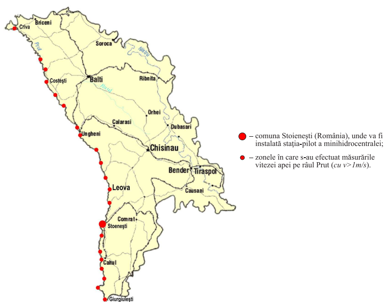
Fig. 1.8. Harta măsurărilor potențialului energetic al râului Prut cu zonele unde s-au atestat viteze v > 1 \text{ m/s} .
