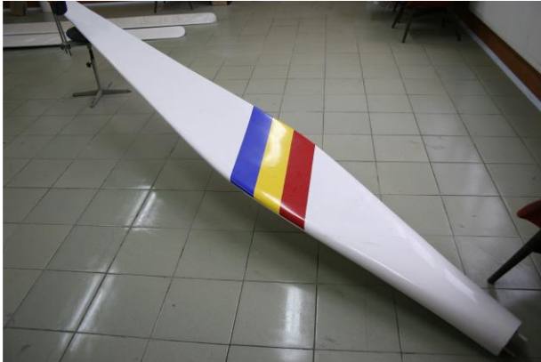
Fig. A.5.9. Fabricarea palelor rotoarelor eoliene cu profil aerodinamic (a, d, e, f) și difuzoarelor divergente (b, c) din materiale compozite, CESCER, UTM.
