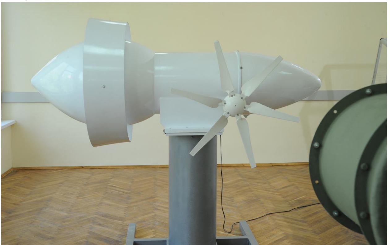
Fig. A.5.1. Cercetarea experimentală a caracteristicilor de putere și celor cinematice ale windrozelor A, D=912\text{mm} (a) și B, D=1120\text{mm} (b).
