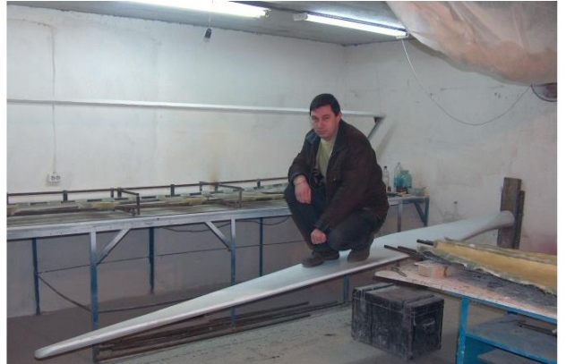
Fig. A.5.9. Fabricarea palelor rotoarelor eoliene cu profil aerodinamic (a, d, e, f) și difuzoarelor divergente (b, c) din materiale compozite, CESCER, UTM.
