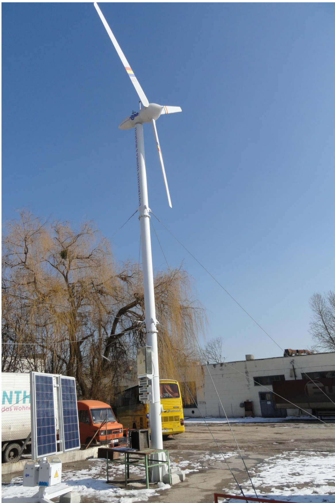
Fig. D.3. Vederea generală a turbinei eoliene (10 kW) cu orientare electronică la direcția curenților de aer (instalată pentru încercări experimentale pe poligonul UTM, CITM “Etalon”, UTM, a. 2011).
