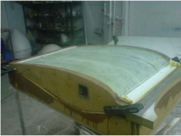
Fig. A.6.13. Procedee tehnologic de fabricare a învelișului palelor cu profilul hidrodinamic cu lungimea cordului l=800\text{mm} cu ecrane pentru direcționarea curgerii fluidelor, CESCER, UTM.
