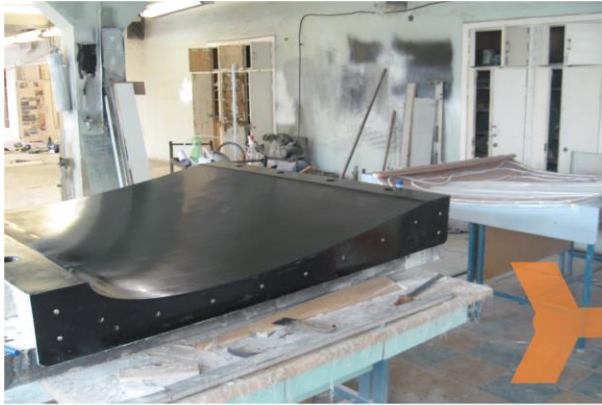
a) Fabricarea formei cu profil NACA 0016 inversat.
