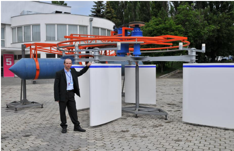
Fig. 6.27. Microhidrocentrală cu rotor hidrodinamic pentru conversia energiei cinetice a râului în energie mecanică utilizată pentru pomparea apei (debitul Q = 40 m 3 /h, înălțimea pomparei H = 10 \div 15 m). 10
