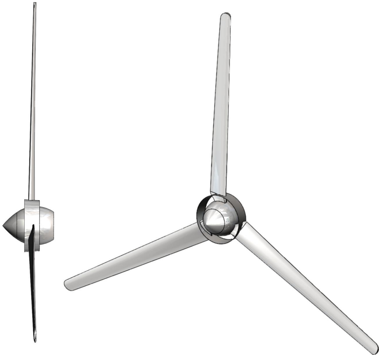
Fig. A.3.6. Modelul CAD al rotorului cu profil aerodinamic II al palelor cu difuzoare convergent și divergent ( \varnothing 8\text{m} ).
