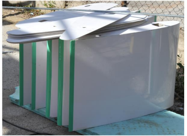
Fig. A.6.13. Procedee tehnologic de fabricare a învelișului palelor cu profilul hidrodinamic cu lungimea cordului l=800\text{mm} cu ecrane pentru direcționarea curgerii fluidelor, CESCER, UTM.
