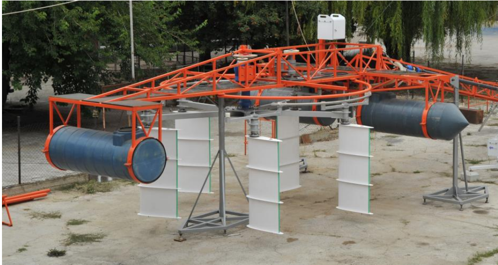
Fig. 6.28. Vederea generală a microhidrocentralei de flux cu rotor hidrodinamic basculant cu 5 pale cu lungimea cordului c = 800 mm și ecrane pentru direcționarea curgerii fluidului. 11
