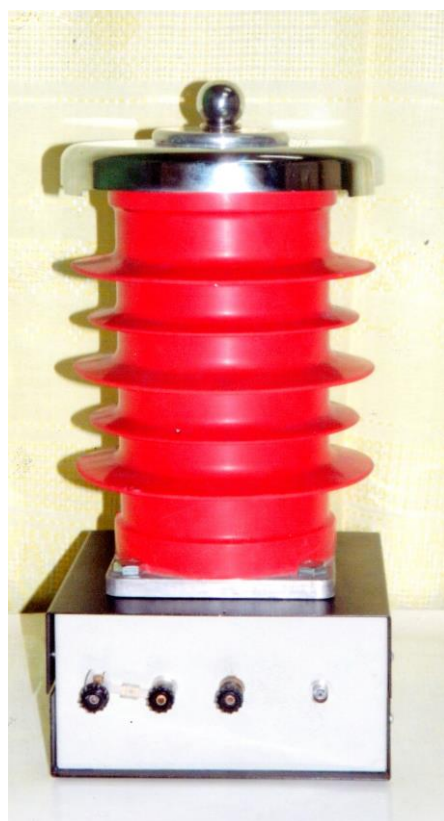
Рис.5. Внешний вид измерительного преобразователя высокого напряжения ИПВН-15.
