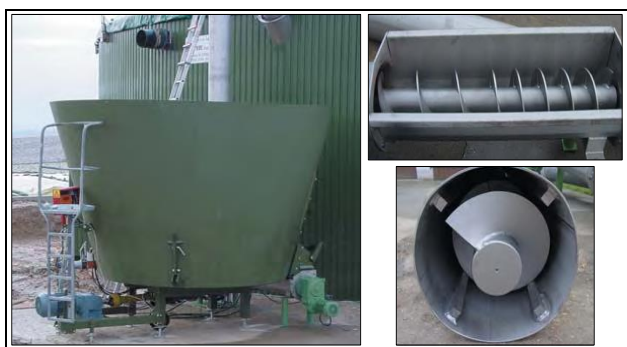
Figura 3. Dozatorul și transportatoare cu șnec, „Luthe GmbH Biogasanlagen”
