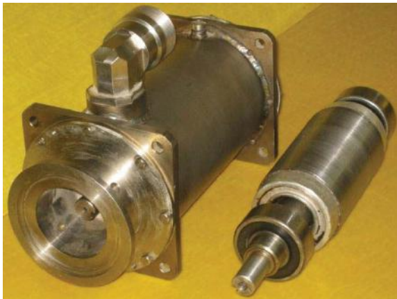
Fig.3. Vedere generală a MA cu 6 faze
