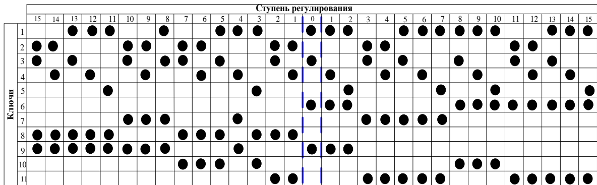
Рис.3.8. Закон управления силовыми ключами
