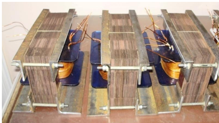
Рис.5.7. Последовательные трансформаторы фазовой установки
