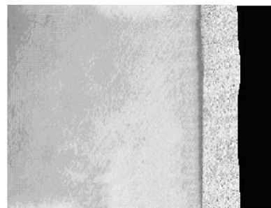
Figura 4. Microstructura martor Cd.90, mărire \times 400 , electrozi verticali, densitatea de curent i = 4 \text{ A/dm}^2
