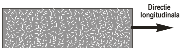
Figura 1. Încărcarea longitudinală a materialelor compozite ranforsate cu fibre discontinue și orientate întâmplător.
