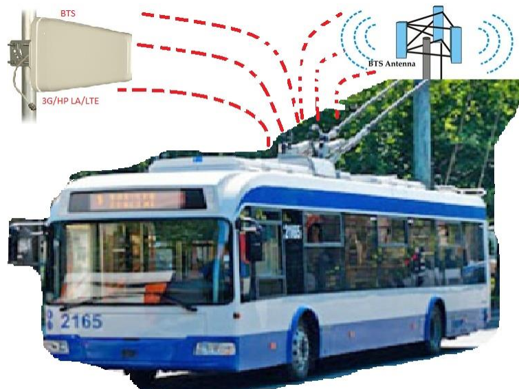
Fig.1. Reprezentarea schițată a realizării legăturii dintre antene prin interfețele radio când troleibuzul se deplasează
