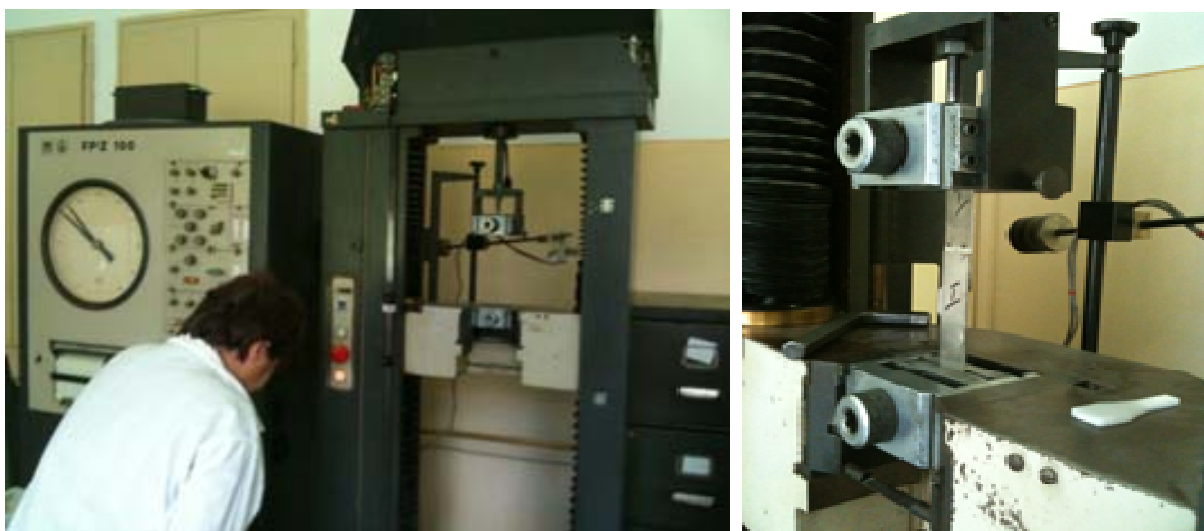
Figura 8. Vederea generală a instalației de încercări la tracțiune, tip HECKERT FPZ 100.
