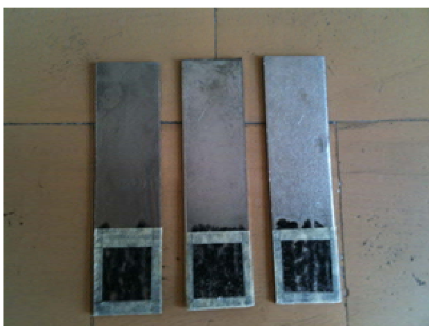
Figura 9. Epruvete tratate pregătite pentru adezivare.
