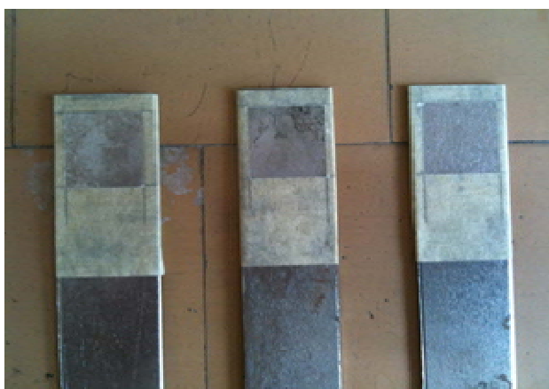
Figura 10. Epruvete netratate pregătite pentru adezivare.
