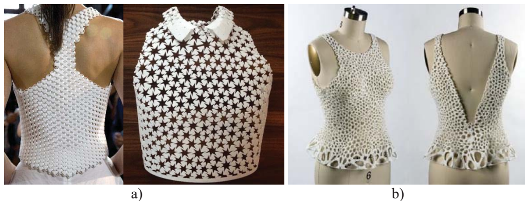
Fig. 3. Produse vestimentare realizate prin imprimare 3D: a) din elemente mici de aceeași dimensiune, b) din elemente variate ca dimensiune și formă
