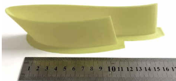
Fig. 3.2. Pală formată din segmentele (1) cu elemente de rigidizare (2)
