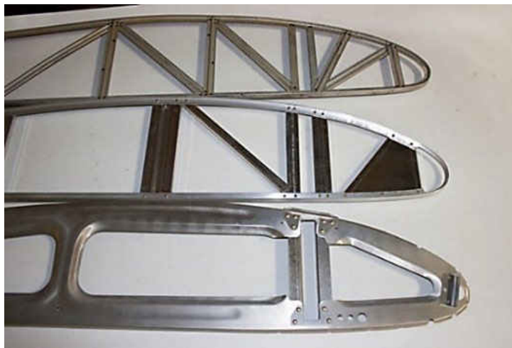
Fig. 1.28. Nervuri în formă de profiluri aerodinamice (sursa: Dakota Cub) [94]
