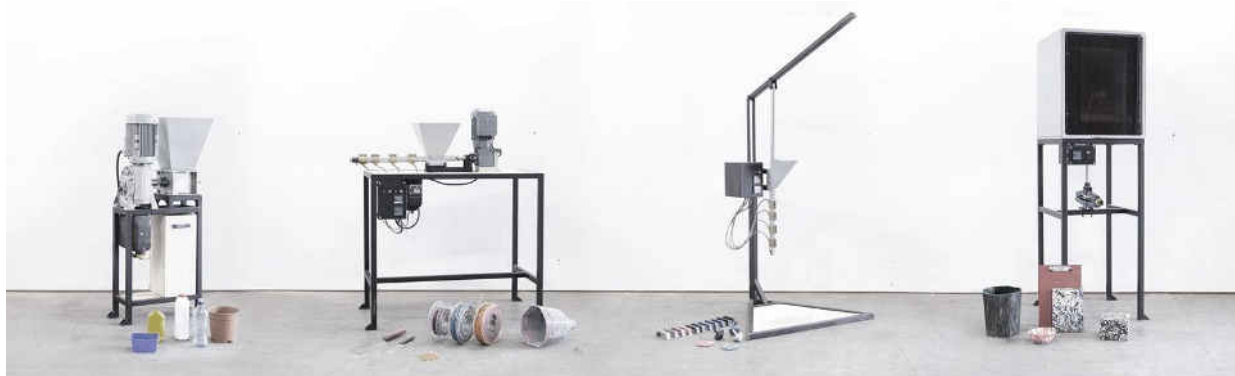
Fig. 3.10. Mașinile de prelucrare a plasticului reciclat. De la stânga la dreapta: mașina de tocat, mașina de extrudat, mașina de injectat, mașina de presat (sursa: Precious Plastic)
