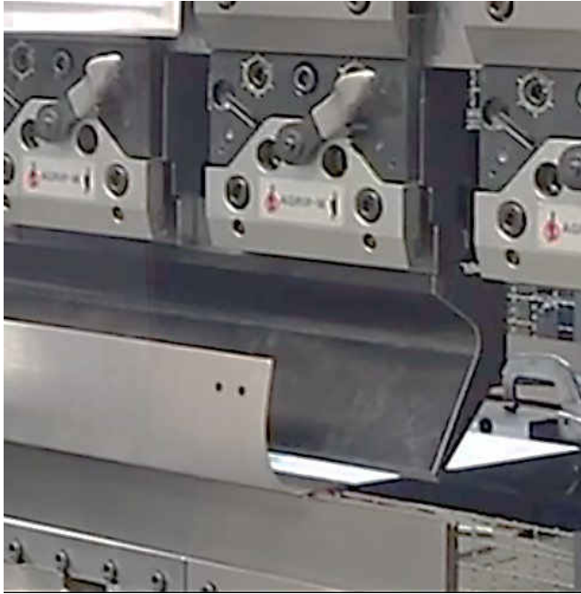
Fig. 1.30. Îndoirea tablei cu grosimea > 1 mm [96]
