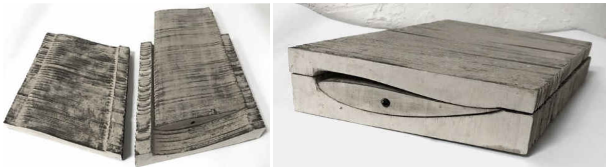
Fig. 3.13. Matrița formată din trei componente
