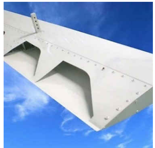
Fig. 1.29. Pală obținută prin îndoire din foaie de aluminiu [95]
