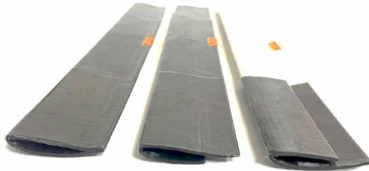
Fig. 2.31. Pale drepte profil aerodinamic FX 63-137, versiunile închisă și cu deschidere pe interior și exterior.
