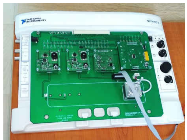
Fig. 2.9. Sistemul de achiziționarea a datelor NI Elvis II cu modulul RELab
