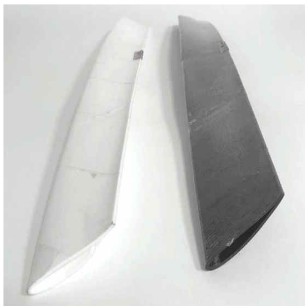
Fig. 2.33. Pale elicoidale profil FX 63-137 curbură exterior, versiunile închisă și cu deschidere interior
