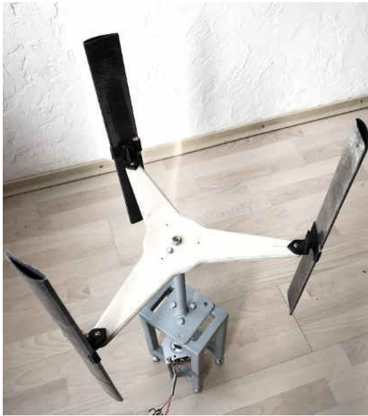
a. Curbură palei orientată spre interior
