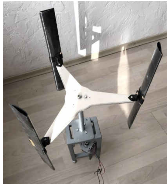
b. Curbură orientată spre exterior
