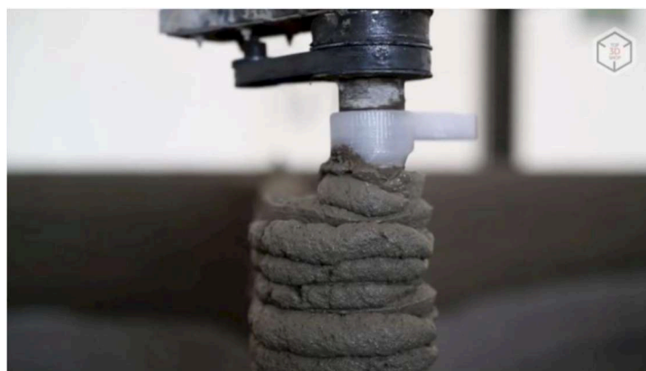
Figura 1. Imprimarea betonului în 3D [1]
