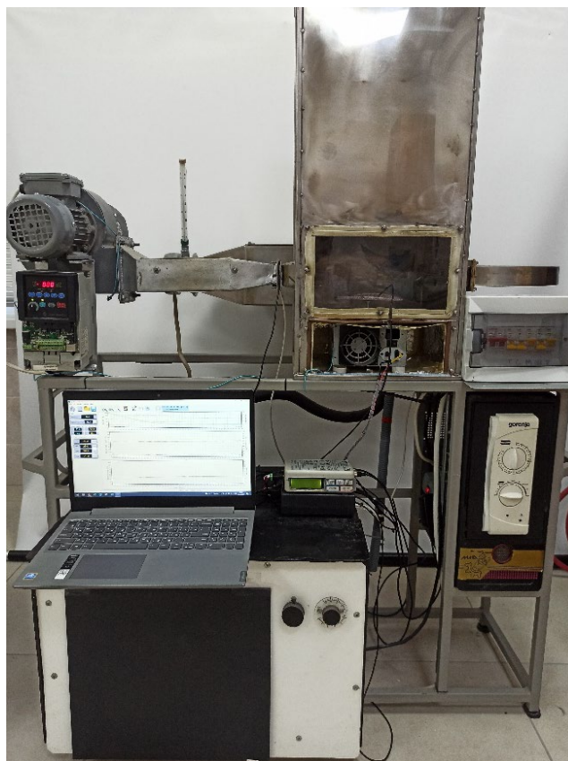
Fig.2.1. Instalația de deshidratare, vedere frontală
