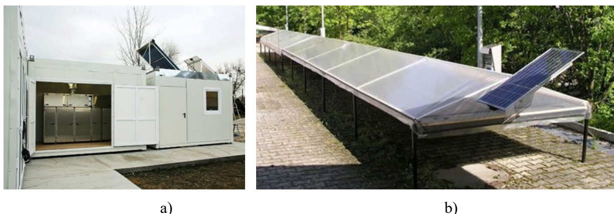
Fig.1.10. Utilizarea energiei solare: (a, b) instalații de uscare cu utilizarea energiei solare
