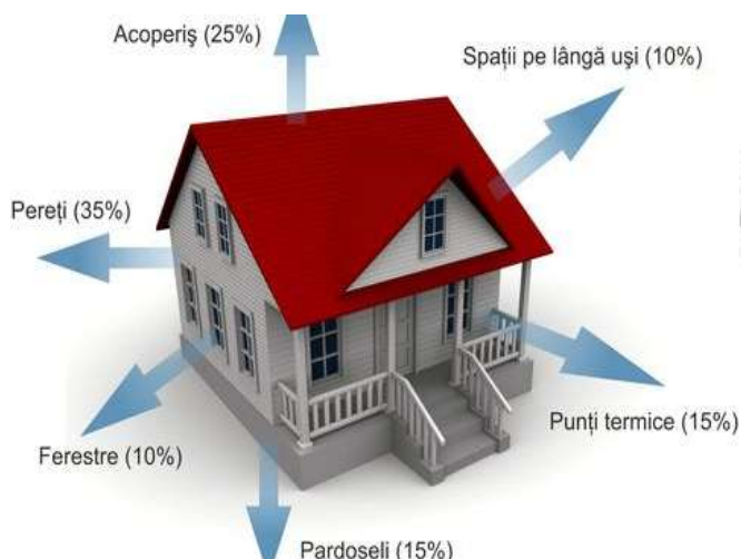
Fig.1.Pierderile de energie prin anvelopă [6]
