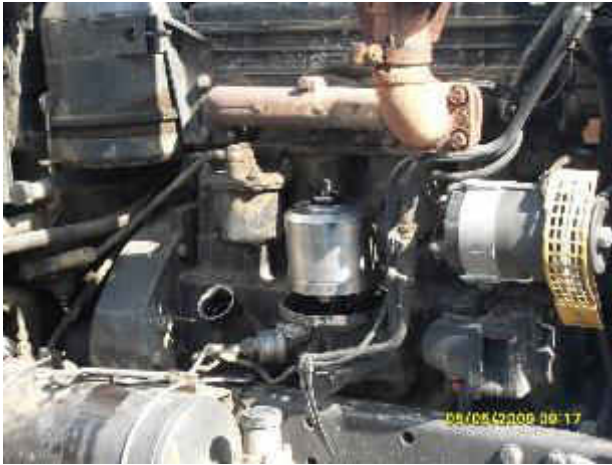
Fig. A2.1. Secvențe din procesul de pregătire a tractoarelor: a) curățirea filtrului (de ulei) centrifugal; b) schimbarea uleiului în baia carterului motorului
