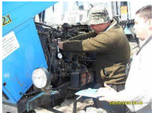
Fig. A2.2. Secvențe din procesul verificării presiunii la sfârșitul compresiei în cilindrii motorului DC4 11,0/12,5: a) pregătirea cilindrului nr.1; b) efectuarea măsurărilor
