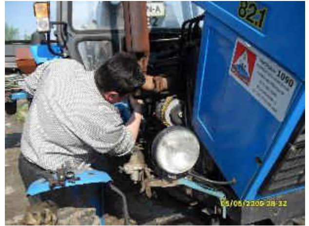
Fig. A2.1. Secvențe din procesul de pregătire a tractoarelor: a) curățirea filtrului (de ulei) centrifugal; b) schimbarea uleiului în baia carterului motorului
