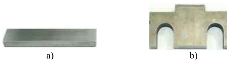
Fig. 2.8. Elementele cuplei tribologice cercetate: a) corp cu suprafața cromată; b) contracorp- fonta cenușie
