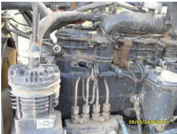
Fig. A2.2. Secvențe din procesul verificării presiunii la sfârșitul compresiei în cilindrii motorului DC4 11,0/12,5: a) pregătirea cilindrului nr.1; b) efectuarea măsurărilor
