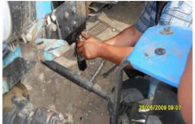
Fig. 2.10. Secvențe din procesul de prelevare a probei uleiului de motor în acțiune
