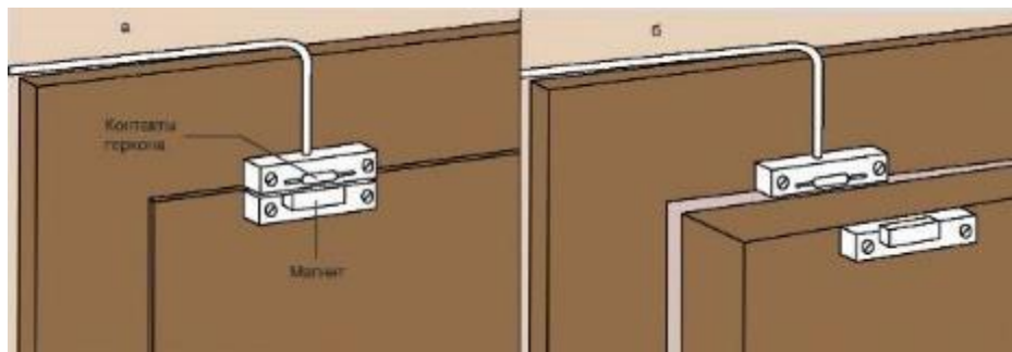
Figura 6 Modul de comandă a senzorului magnetic: a) în poziție de control; b) în poziția activă;
