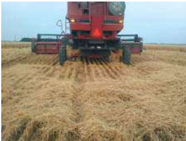
Figura 6. Gestionare incorectă a reziduurilor de grâu
