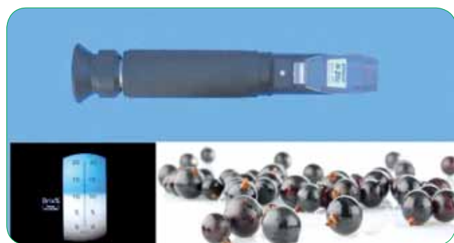
Fig. 9.1. Refractometru manual, modelul ATAGO N-20E
