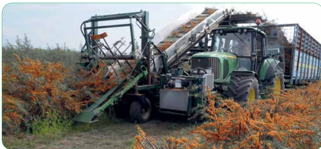
Fig. 7.25. Recoltarea mecanizată a fructelor de cătină albă. Diferite tipuri de combine utilizate la recoltarea mecanizată
