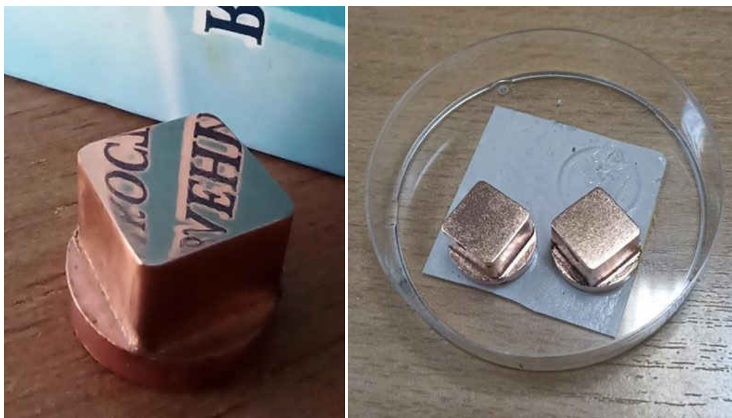
Рис. 3. Медные образцы, на торцах которых осуществляется кипение жидкости в микканале. Полированный образец (до отжига) перед синтезом графена (слева); образцы, покрытые графеном (справа).
