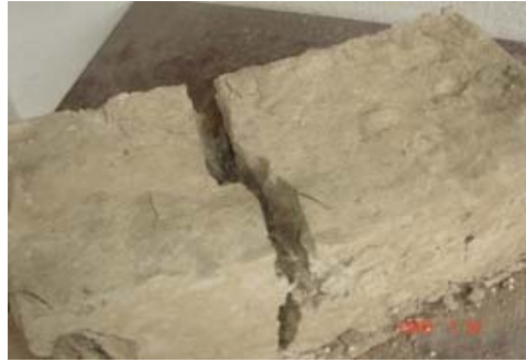
Fig.4 Bloc din argilă curată, crăpat după uscare în rezultatul contracției.
