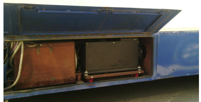
Fig.4. Sistemul SDMC-103-05 montat în troleibuz.
