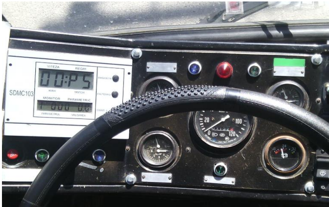
Fig.7. Modulul PDC montat în panoul șoferului.
